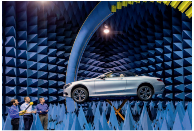
Test und Bewertung automobiler Funkssysteme in der Prüfanlage „Virtuelle Straße“ (VISTA) am Thüringer Innovationszentrum Mobilität (ThIMo) der TU Ilmenau.
